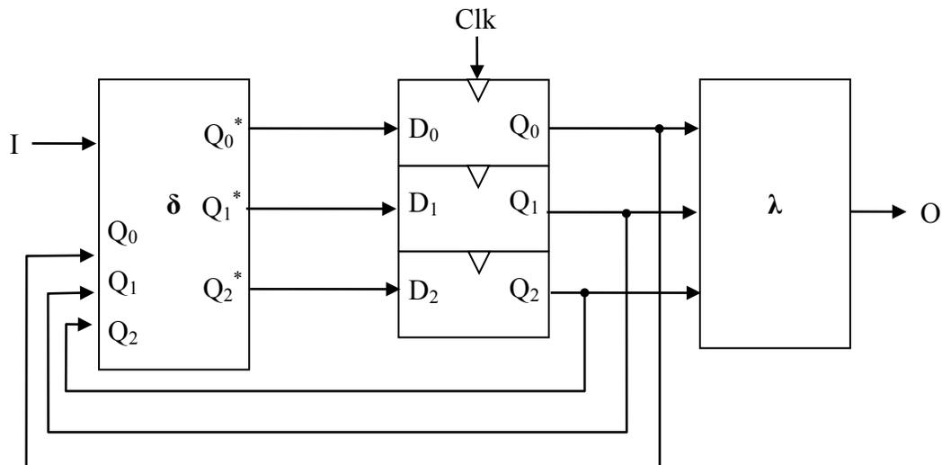
Per sintetizzare le funzioni stato prossimo e di uscita occorre definire una corrispondenza tra gli stati del sistema e le configurazioni possibili dei latch, così come occorre definire una mappatura per le configurazioni in ingresso ed uscita.
